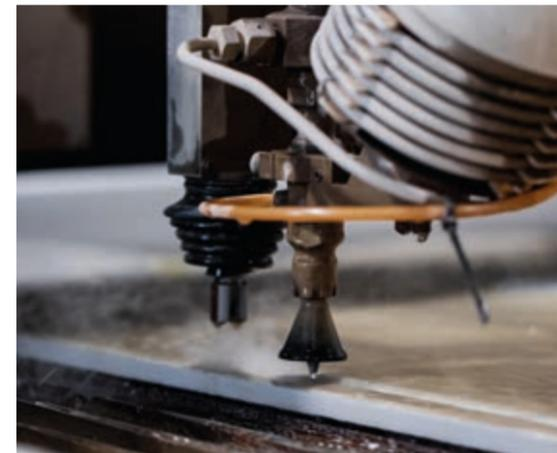
Die industrielle Fertigung ermöglicht den Zuschnitt und die Verarbeitung der Großformatkeramik in einer Perfektion und Genauigkeit, die man durch den Zuschnitt auf der Baustelle nicht gleichbleibend gewährleisten könnte. Denn die Qualität der Zuschnitte durch eine Wasserstrahlanlage, kann mit herkömmlichem Werkzeug nicht erreicht und nur durch die industrielle Vorfertigung sichergestellt werden.
