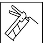
Um das Eindringen von Wasser zwischen Wand und Waschtisch zu vermeiden, muss die Anschlusskante mit einer Silikonfuge abgedichtet werden. Verwenden Sie ausschließlich neutral vernetztes (lösemittelfreies) Silikon.
