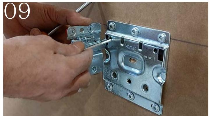
09 Bei Bedarf Sicherheitsanker betätigen zum Aushängen des Korpus.
